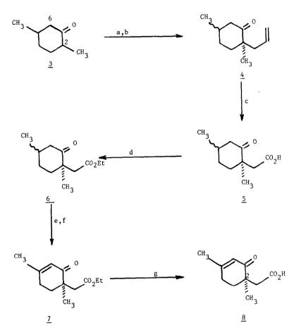
a) NaH, DME; b)  $BrCH_2CH=CH_2$ ; c)  $RuO_4$ ,  $NaIO_4$ ,  $H_2O$ , t-BuOH; d) EtI,  $K_2CO_3$ , acetone; e)  $Br_2$ , HOAc; f)  $CaCO_3$ , DMA; g) KOH, EtOH,  $H_2O$ .
